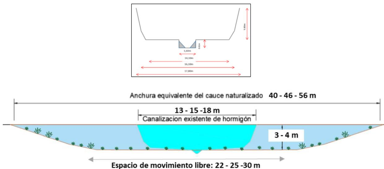
Imagen 8: Planteamiento del CEDEX para adecuación de tramos hormigonados a demoler
